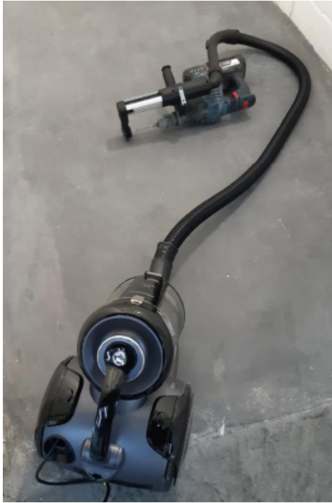
Image 9 : système de raccordement de la perceuse à sec avec un aspirateur filtration HEPA. ©Archives nationales.
