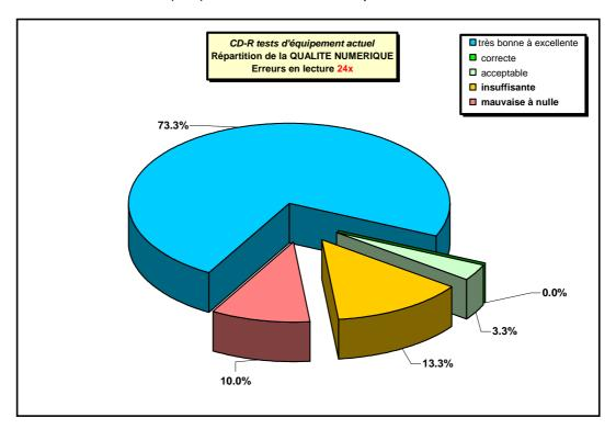
L'augmentation de la vitesse de lecture à 24x vient confirmer les propos établis à basse vitesse, à savoir près de ¾ des disques d'un niveau très bon à excellent et 23 % de qualité insuffisante ou mauvaise (1 disque de plus qu'en 1x sur le niveau insuffisant).
