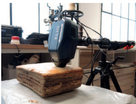
Registre de la statue de Napoléon à Rouen, analyse en fluorescence X.
